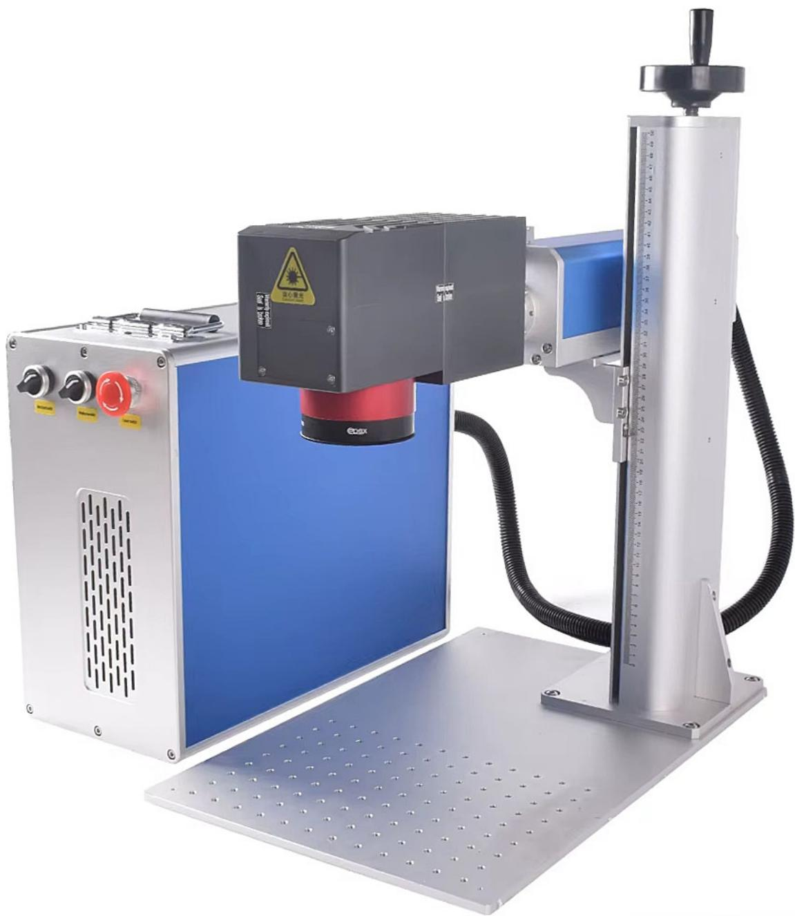
Zahvaljujući **3D tehnologiji glave**, možete gravirati duboko na neregularnim objektima poput kugli, zakriviljenih površina, prstenova, cilindričnih objekata i mnogim drugim neregularnim oblicima koje obični FIBER laser gravirači ne mogu obraditi.
