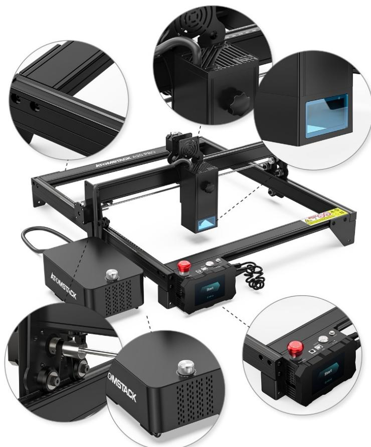
**Ultra lagana i izdržljiva konstrukcija** - stroj za graviranje teži samo 5,5 kg, njegov okvir je u potpunosti izrađen od izdržljivih aluminijskih profila. Sastavljanje svih elemenata stroja ne traje više od 15 minuta. Može se slobodno premještati s mjesta na mjesto, a radna površina iznosi čak **400x400 mm**, što daje široku paletu mogućnosti u pogledu izvođenja projekata.
