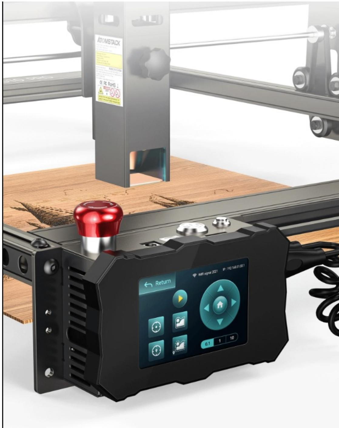
Ploča s korisnim gumbima i priključcima: Stroj možemo zaustaviti u bilo kojem trenutku crvenom tipkom - sigurnosnom tipkom STOP, pored nje imamo spojne konektore, tipku za brzo paljenje i gašenje graverice i RESET tipku koja zaustavlja rad, isključuje terminal i ponovno pokreće uređaj.
