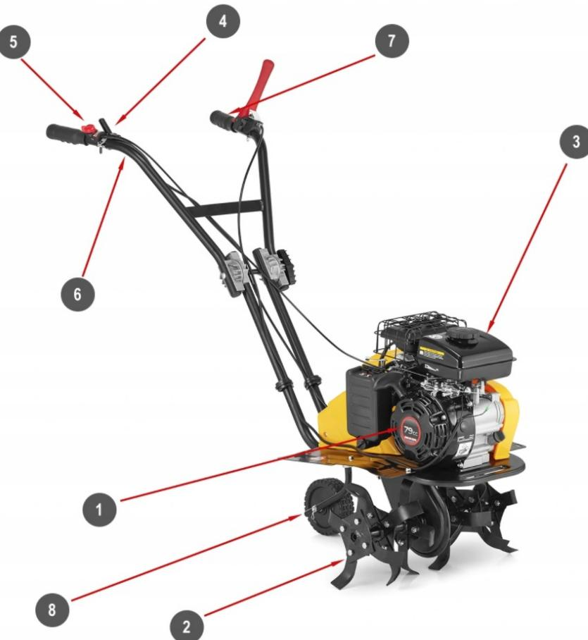
1. **4-taktni motor s unutarnjim izgaranjem visoke klase renomirane marke LONCIL** obujma 79cm<sup>3</sup> i snage 3,5KS s tranzistorskim magnetskim paljenjem.
